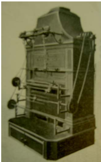
I.20- Rôtisserie pour hôtel avec mouvement vertical type Cubain
